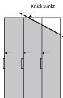
Eine **seitliche Abschrägung** ist nur an Elementen mit 1 Drehtür bzw. 1 Falлтürenpaar möglich. Der Türanschlag muss immer an der höher verbleibenden Seite liegen.
