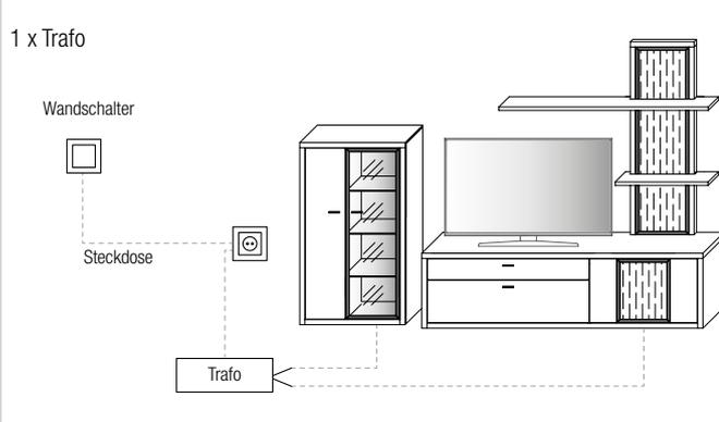
Bitte am Ende Ihrer Planung die Gesamtwattzahl ermitteln und den/die entsprechende(n) LED-Trafo(s) sowie die gewünschte Schaltervariante(n) definieren. Optional kann der Schalter durch einen Funkdimmer ersetzt werden, sodass Sie die Beleuchtung per Fernbedienung bequem vom Sofa aus steuern können. Diesbezüglich sollte dem Auftrag unbedingt eine Planungsskizze hinzugefügt werden.
